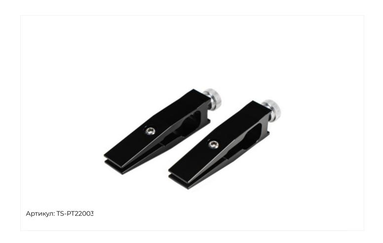
**Цельнофрезерованные зажимы TSPROF Kadet** надежно фиксируют ножи с толщиной обуха до 7 мм. Изготовленные из цельного бруска высокопрочного алюминиевого сплава. Зажатие происходит за счет стягивание губок зажима винтом M6x16 из нержавеющей стали. Зажимы не нуждаются в калибровке.
