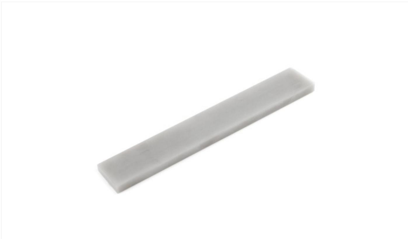
**Arkansas Translucent** – натуральный камень для заточки. Относится к породам микрокварцита (новакулита). Эффективно работает по большинству сталей. Отличается высокой однородностью зерна и чистотой работы. Применяется для финишной заточки и создания микроподвода.
