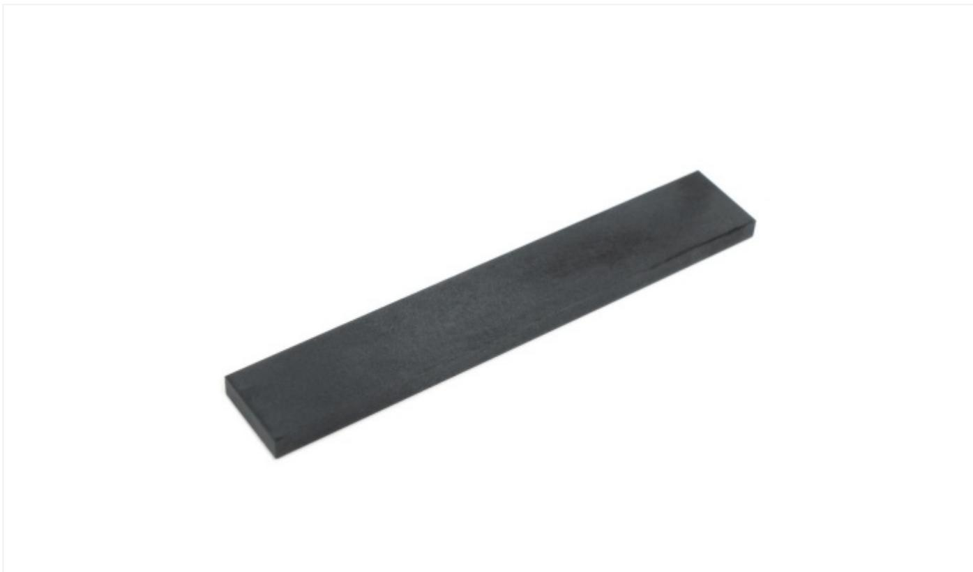
**Arkansas Black** – натуральный камень для заточки. Относится к породам микрокварцита (новакулита). Эффективно работает по большинству сталей. Отличается высокой однородностью зерна и чистотой работы. Применяется для финишной заточки и создания микроподвода.
